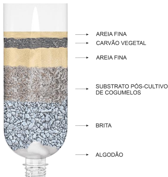
Figura 1: Esquema de montagem do micofiltro.
