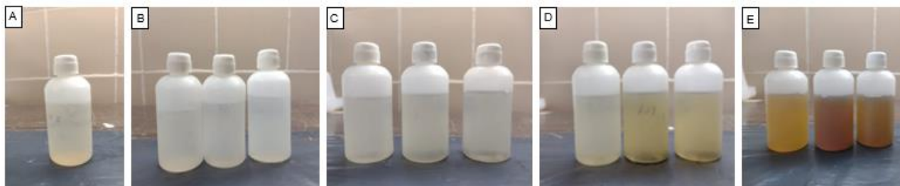
Figura 5: Avaliação qualitativa da água filtrada nos micofiltros; A) água contaminada; B) tratamento controle (filtro padrão); C) Micofiltro com SMS de fibra de coco; D) Micofiltro com SMS de bagaço de cana; E) Micofiltro com SMS de borra de café.
