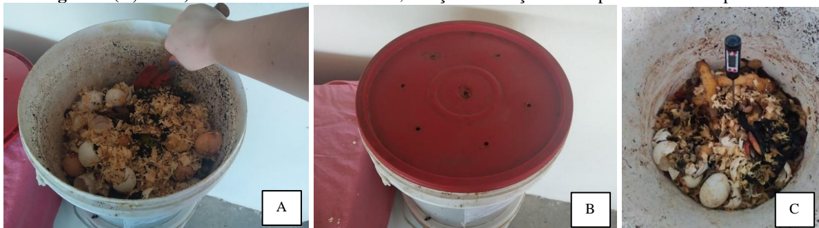
Figura 2 (A, B e C) – Processo de revolvimento, aeração e medição da temperatura nas composteiras
