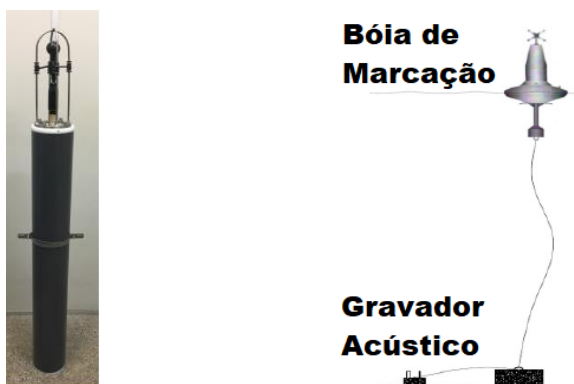
Figura 8 – Gravador acústico autônomo SAASS™ (esquerda) e layout do observatório submarino raso (direita)
